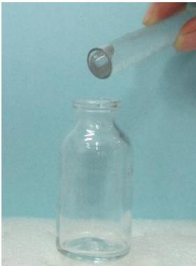
1. Rửa lọ thủy tinh bằng nước sạch. Tráng ống bằng mẫu nước cần đo. Cho 1 ống mẫu nước vào lọ.
